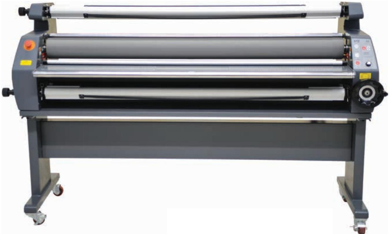
Der **LFPpro STL1600** ist das ideale Einstiegsgerät für professionelles laminieren von Digitaldrucken. Eine solide Bauweise mit einer integrierten Abwickelwalze für das bedruckte Medium als auch eine fest integrierte Aufwickelwalze für die fertig laminierten Digitaldrucke sind standardmäßig am Gerät vorhanden.
