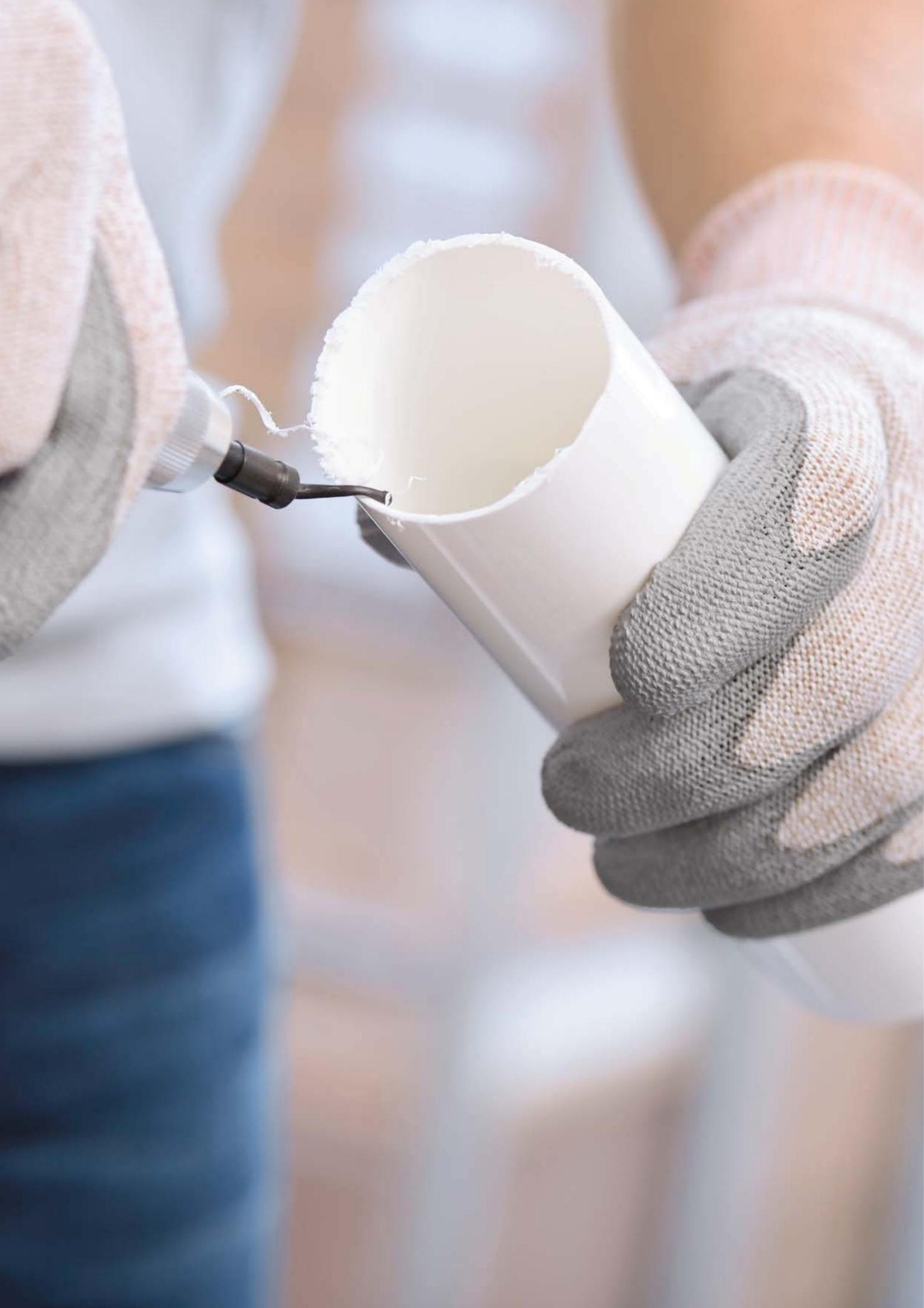
Den letzten Schliff für Ihr Werkstück? Erreichen Sie durch den Einsatz unserer hochwertigen Entgratewerkzeuge. Die TRIMMEX-Familie von MARTOR verwenden Sie zum Entgraten weicher und harter Materialien, auf Innen- und Außenkanten, an runden und geraden Flächen. Unsere große Auswahl an passenden Griffen und Klingen ist dabei die Basis für ein sauberes Ergebnis.
