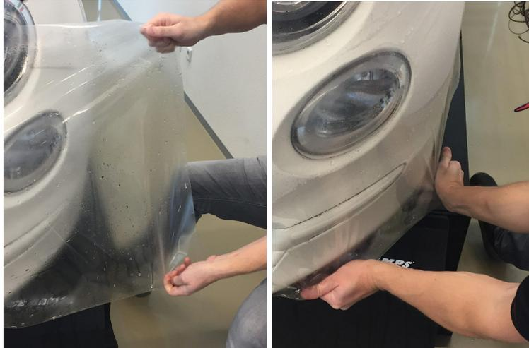
Herkömmliche konvexe und Verbundformen an Fahrzeugfronten eignen sich überwiegend für eine Beklebung mit allen Lackschutzfolien der SPF-Serie von Avery Dennison, bei tieferen Rillen muss man die Folie gegebenenfalls einschneiden, damit hier keinerlei Luft- und Wassereinschlüsse verbleiben. Funktion und Haltbarkeit des Produkts werden durch diese Schnitte nicht beeinträchtigt.
